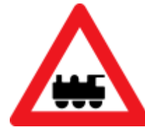
A72: Jernbaneoverkørsel uden bomme
