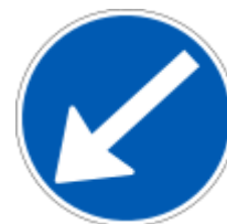
D15.2: Påbudt passage
