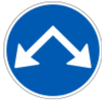
D16: Påbudt Passage
